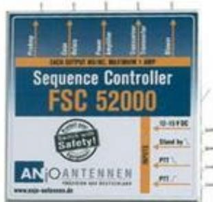
Durch die zwangsweise Steuerung mit vorgegebenem zeitlichem Ablauf von Vorverstärker, Koax-Relais, Endstufe und Transceiver / Transverter sind die Umschaltvorgänge von Empfang nach Senden und zurück nach Empfang, zu jedem Zeitpunkt kontrolliert.
