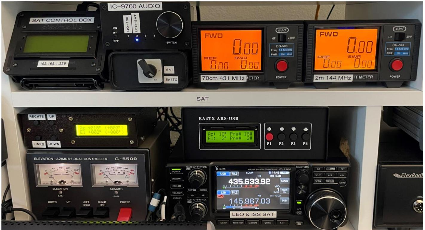
Als Backup kann ich noch den WinrotorPlus Adapter am YAESU Steuergerät anschliessen (COM 10) und damit den Rotor mit SATPC32 und PstRotor steuern.
