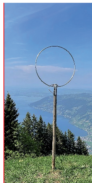
Bild 5: Wellbrook ALA 1530LN Loop für WebSDR-Server
