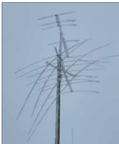
Die zerstörte OptiBeam OBDYA12-5
